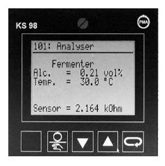
仪器将局部显示重要的工艺数值(如乙醇浓度,温度和传感器电阻)。为了控制流程,这可以转换成标准的电流信号和两个限制继电器触点,用作任何流程控制系统的输入信号,或视像化和/或转化成文档。
