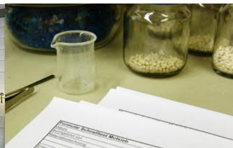
Каждая партия материала для молекулярного сита подвергается экспресс-испытаниям перед загрузкой.
